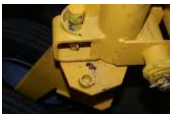
Ограничитель на сеялке СКП-2,1 других производителей
